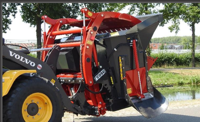
Mengbak met optioneel intrekbord en verlengde uitglijgoten
