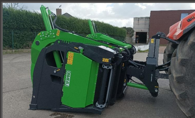
Voederbak met bodemketting aan tractor, met optie kuilhapper
