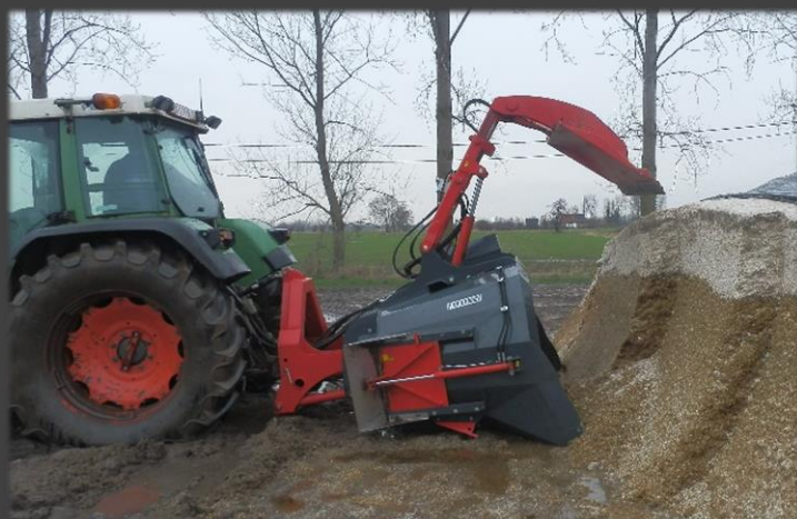
Verticale mengbak kantelend aan tractor met telescopische zaag
